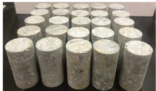
图1 充填混凝土试件
