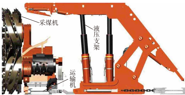
图9 工作面采煤设备布置
